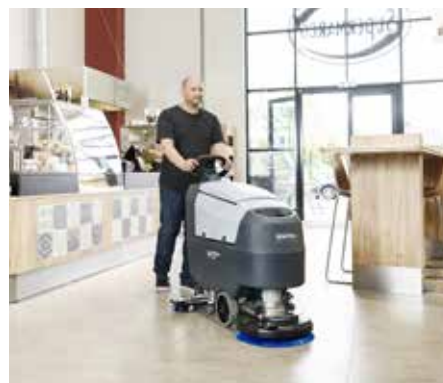
A tecnologia SilentTech™ da Nilfisk reduz o nível sonoro para 65dB(A) - a 60dB(A) no modo silencioso
